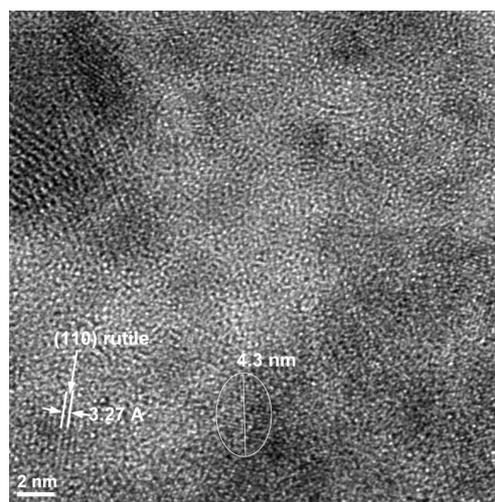
Fig. 2k- Image of high-resolution transmission electron microscopy (HRTEM); very small nanoparticle (between 3 nm and 5 nm) in the region with  $\text{TiO}_2$  majority / *Imagine de microscopie electronică prin transmisie de înaltă rezoluție (HRTEM); nanoparticule foarte mici (între 3 nm și 5 nm) în regiunea cu  $\text{TiO}_2$  majoritar*
