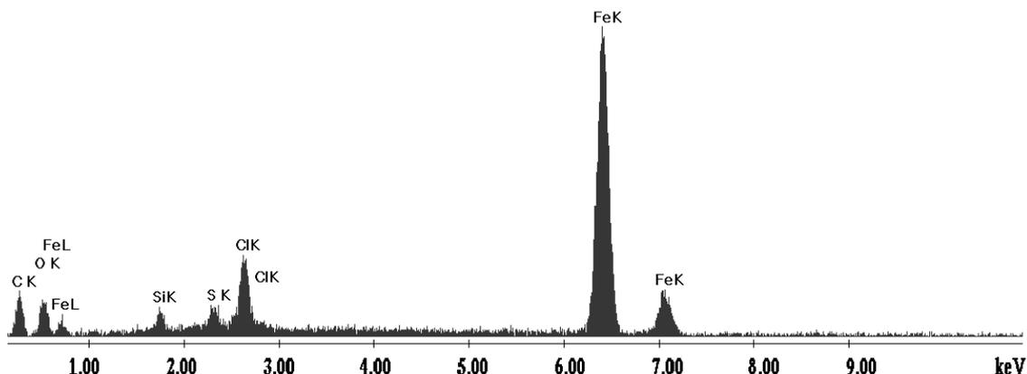
Fig. 1e. - Energy dispersive X-ray spectrum (EDAX) obtained on the nano-area from Fig. 1a / Spectrul de raze X în energie dispersată (EDAX) obținut pe nano-zona din Fig.1a.
