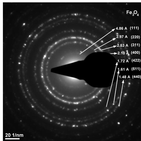
Fig. 2b- Image of electron diffraction (SAED) associated to the EDX1 area in Fig. 2a / Imagine de difracție de electroni (SAED) asociată ariei EDX1 din figura 2a.
