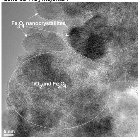
Fig. 2f- Image of high-resolution transmission electron microscopy (HRTEM) – detail from Fig. 2e / *Imagine de microscopie electronică prin transmisie de înaltă rezoluție (HRTEM) – detaliu din figura 2e.*
