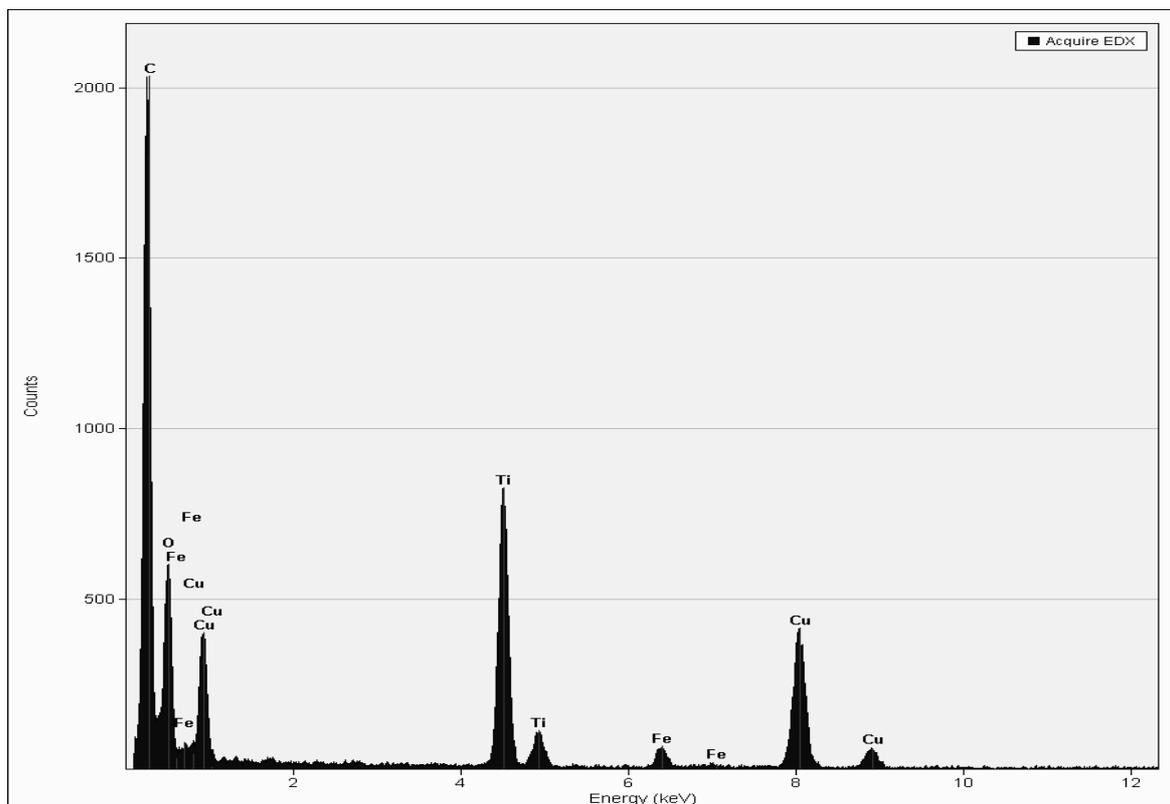
Fig. 2d- Energy dispersive X-ray spectrum (EDAX) obtained on the nano-area indicated with EDX1 in Fig.2a / Spectrul de raze X în energie dispersată (EDAX) obținut pe nanoaria indicată cu EDX1 din figura 2a.
