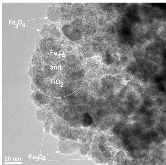
Fig. 2e -Image of transmission electron microscopy in bright field (TEM BF) presenting a set of nanoparticles; larger magnetite nanoparticles and areas with  $TiO_2$  majority / *Imagine de microscopie electronică prin transmisie în câmp luminos (TEM BF) ce prezintă un ansamblu de nanoparticule; nanoparticule mai mari de magnetită și zone cu  $TiO_2$  majoritar.*
