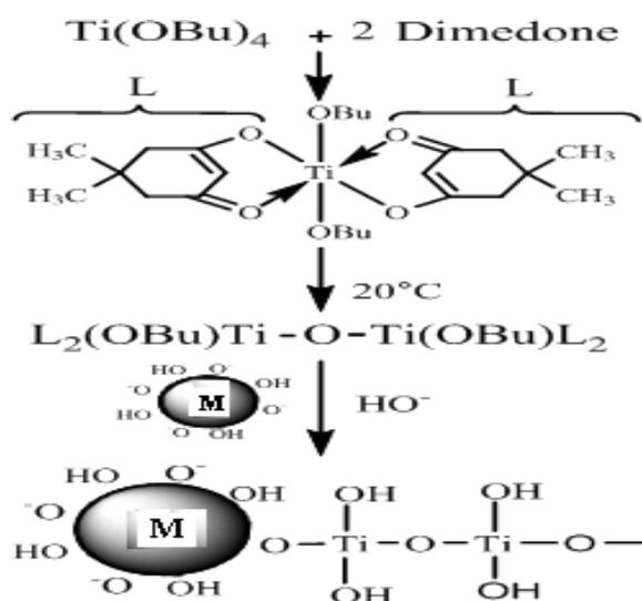
Scheme I - Reaction of coating magnetic nanoparticles with titanium dioxide in the presence of dimedone (M=magnetite) / Reacția de acoperire a nanoparticulelor magnetice cu dioxid de titan, în prezența dimedonei (M = magnetită).
