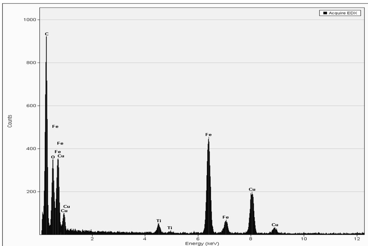
Fig. 2c- Energy dispersive X-ray spectrum (EDAX) obtained on the nano-area indicated with EDX2 in Fig.2b / Spectrul de raze X în energie dispersată (EDAX) obținut pe nanoaria indicată cu EDX2 din figura 2b.
