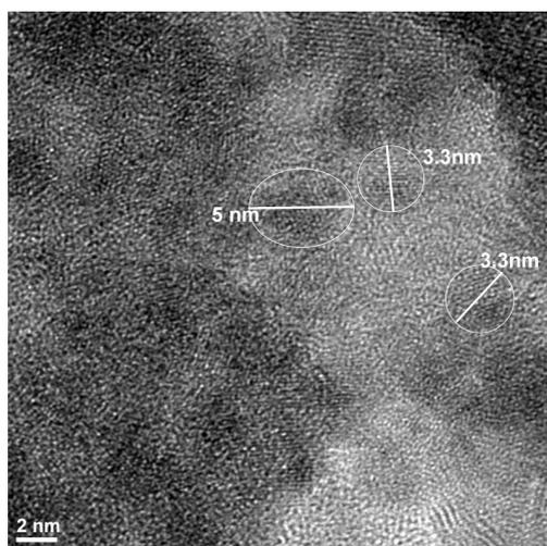
Fig. 2j- Image of high-resolution transmission electron microscopy (HRTEM); very small nanoparticles (between 3 nm and 5 nm) in the region with  $\text{TiO}_2$  majority / *Imagine de microscopie electronică prin transmisie de înaltă rezoluție (HRTEM); nanoparticule foarte mici (între 3 nm și 5 nm) în regiunea cu  $\text{TiO}_2$  majoritar*
