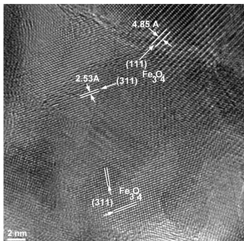
Fig. 2h- Image of high-resolution transmission electron microscopy (HRTEM) – detail from Fig. 2g / *Imagine de microscopie electronică prin transmisie de înaltă rezoluție (HRTEM) – detaliu din figura 2g.*
