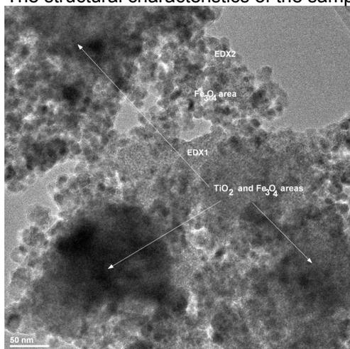
Fig. 2a- Image of transmission electron microscopy in bright field (TEM BF) presenting a set of nanoparticles / Imagine de microscopie electronică prin transmisie în câmp luminos(TEM BF) ce prezintă un ansamblu de nanoparticule.
