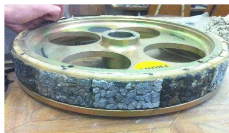
Fig. 3 – Aggregate samples fixed on the wheel of PSV machine / Probe de agregate fixate pe roata aparatului de PSV.
