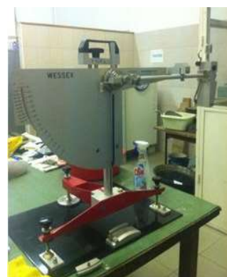
Fig. 4 – Second stage of PSV test - Skid-Resistance measurement / A doua etapă a încercării PSV – măsurarea rugozității
