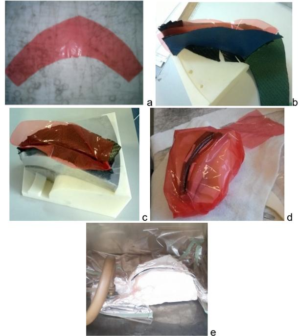
Fig. 13 - Mould closing and vacuum bag assembly: a) release film; b, c) release film integration between prepreg plies; d) the mould wrapped in release film; e) vacuum bag assembly / Închiderea matritei și realizarea sacului de vid: a) release film; b, c) integrarea stratului de release film între pliurile de prepreg; d) înfășurarea matritei în release film; e) sacul de vid.
