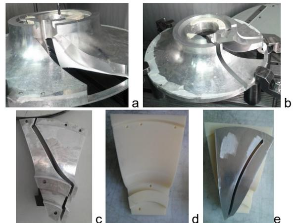
Fig. 6 - Triplet mould: a, b) The preform machining process; c) Type 1 and 2 metallic components; d) ABS base component; e) the triplet mould / Matrița triplet: a, b) Prelucrarea semifabricatelor; c) Componentele metalice de tip 1 și 2; d) Componenta de bază din ABS; e) Matrița triplet.
