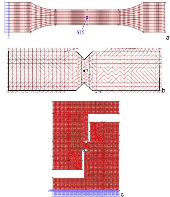
Fig. 8 – FEM models: a) specimen model for tensile test; b) specimen model for shear test; c) Iosipescu device and specimen for shear test / *Modele FEM: a) modelul epruvetei pentru încercarea la tracțiune; b) modelul epruvetei pentru încercarea la forfecare; c) dispozitiv Iosipescu cu epruveta pentru încercarea la forfecare.*
