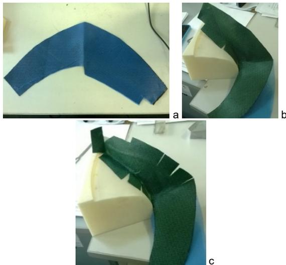
Fig. 11 - Lay-up of the first prepreg ply / Așezarea primului pli de prepreg.
