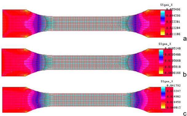
Fig. 15 – Stress distribution in one material ply in case of tensile test: a) for CC 370 ER 450; b) for CC 402 ER 450; c) HexPly M49 / Distribuția tensiunii într-un pliu de material în cazul încercării la tracțiune: a) pentru materialul CC 370 ER 450; b) pentru materialul CC 402 ER 450; c) pentru materialul HexPly M49.
