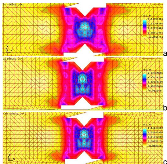
Fig. 16 – Stress distribution in one material ply in case of shear test: a) for CC 370 ER 450; b) for CC 402 ER 450; c) HexPly M49 / Distribuția tensiunii într-un pliu de material în cazul încercării la forfecare: a) pentru materialul CC 370 ER 450; b) pentru materialul CC 402 ER 450; c) pentru materialul HexPly M49.
