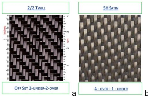
Fig. 7 – Woven carbon fabrics used for technical trials [15] / *Țesăturile din fibră de carbon utilizate pentru testele tehnologice.*
