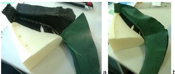
Fig. 12 - Lay-up of the second prepreg ply / Așezarea celui de-al doilea pli de prepreg.
