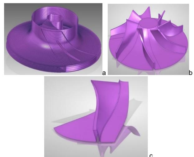
Fig. 2 - a) Remodeling Rotor surfaces; b) New version of centrifugal rotor surface; c) One blade surface / a) Remodelarea suprafețelor rotorului; b) Noua versiune a suprafeței rotorului centrifugal; c) Suprafața unei palete.
