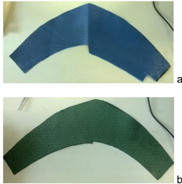
Fig. 10 - Prepreg forms used as models: a) type 1 prepreg form; b) type 2 prepreg form / Șabloanele utilizate ca model pentru pliurile de prepreg: a) șablon pentru pliul de tip 1; b) șablon pentru pliul de tip 2.
