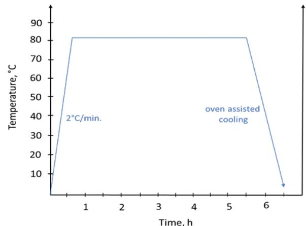
Fig. 14 - Curing cycle used for all prepreps / Ciclul de polimerizare utilizat pentru toate preprepurile.
