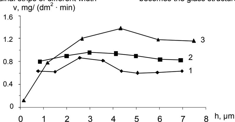
Fig. 4 - Rate of dissolution of flat glass, treated by electromagnetic fields. The samples rotated in the HF solution. Duration of one etching – 10 minutes. / Viteza dizolvării sticlei de geam, tratată cu câmpuri electromagnetice. Probele au fost rotite în soluție HF. Durata unei decapări - 10 minute.
