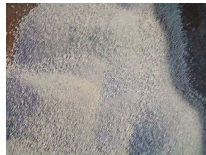
Sample of the P2 slag / Proba de zgură P2 Apparent density = 0.99 g / cm 3 on dried sample Densitate aparentă = 0,99 g/cm 3 în stare uscată
