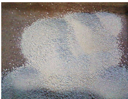
Sample of the P1 slag / Proba de zgură P1 Apparent density = 1.055 g / cm 3 on dried sample Densitate aparentă = 1,055 g/cm 3 în stare uscată
