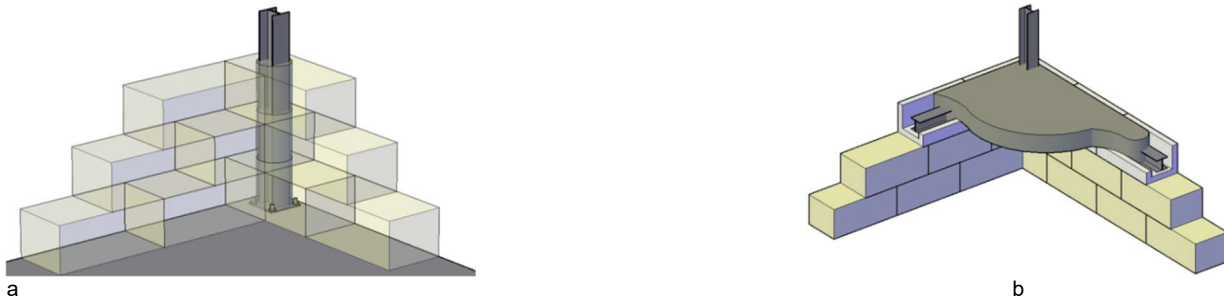
Fig. 6 - Detail of the steel-concrete composite element / Detaliu element compozit oțel-beton : a. vertical steel-concrete composite element (column), placed in permanent formwork of AAC blocks type „O” / element vertical compozit oțel-beton (stâlp), situat în interiorul blocurilor de BCA de tip „O” , b. horizontal steel-concrete composite element (beams, belts), placed in permanent formwork of AAC blocks type „U” / element orizontal compozit oțel-beton (grinzi, centuri), situat în interiorul blocurilor de BCA de tip „U” .
