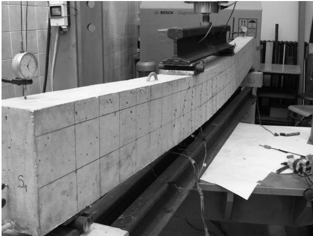
Fig. 11 - Beam deformation under loading / Deformația grinzii sub încărcări ( \Delta_{\max} = 78 mm).
