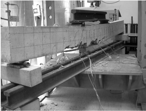
Fig. 15 - Failure resulting from the loss of adhesion of CFRP reinforcement (before slipping crack width is \delta_{max}=1.1 mm) / Cedarea datorată pierderii aderenței armăturii din CFRP (Înainte de alunecare deschiderea fisurilor a fost \delta_{max}=1.1 mm).
