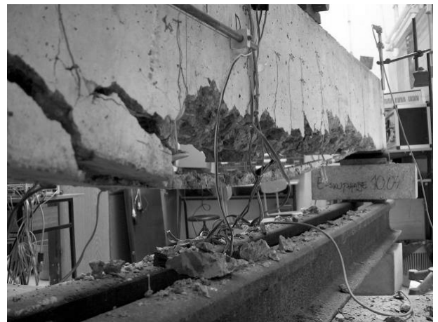
Fig. 18 - Separation of concrete at the height of the concrete cover (back side of the beam) / Separarea betonului pe înălțimea stratului de acoperire cu beton a armăturii și distribuția fisurilor (pe partea din spate a grinzii).
