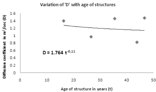
Fig. 7 - Relation between D and t/ Variația coeficientului de difuzie, D, în funcție de vârsta, t, a betonului.
