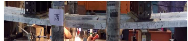
c) YDB-2 side crack
