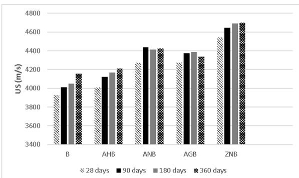
Fig. 5 - The ultrasonic pulse velocity evolution of the concretes/ *Evoluția vitezei de propagare a ultrasunetelor.*
