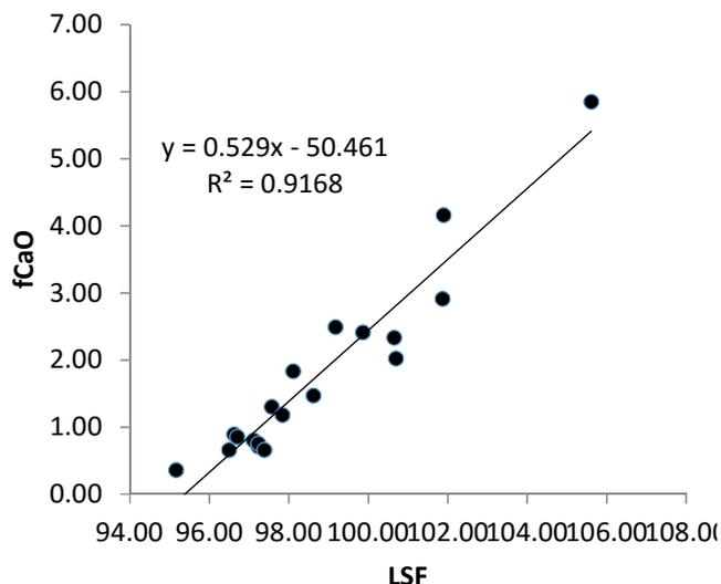
Fig. 6 - *fCaO* vs LSF dependence for data from *S4* / Dependenta *fCaO* vs LSF pentru datele din sistemul *S4*.
