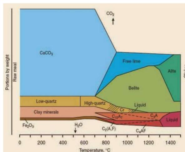
Fig. 1 - Temperature dependent transformation of minerals into clinker [1]/Transformarea mineralelor în clincher în funcție de temperatură [1].
