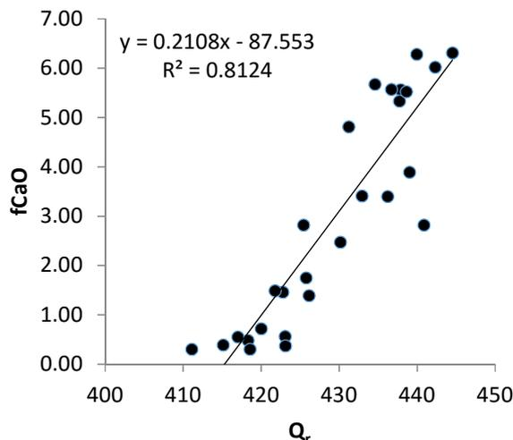
Fig. 7 - *fCaO* vs *Q<sub>r</sub>* dependency for data from system *S5*/Dependenta *fCaO* vs *Q<sub>r</sub>* pentru datele din sistemul *S5*
