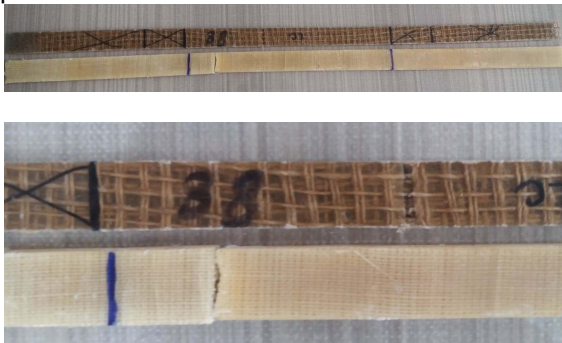
Fig. 6 - The breaking section macroscopic shape for the 1 and 3 samples / Forma macroscopică a secțiunii de rupere pentru epruvetele 1 și 3.
