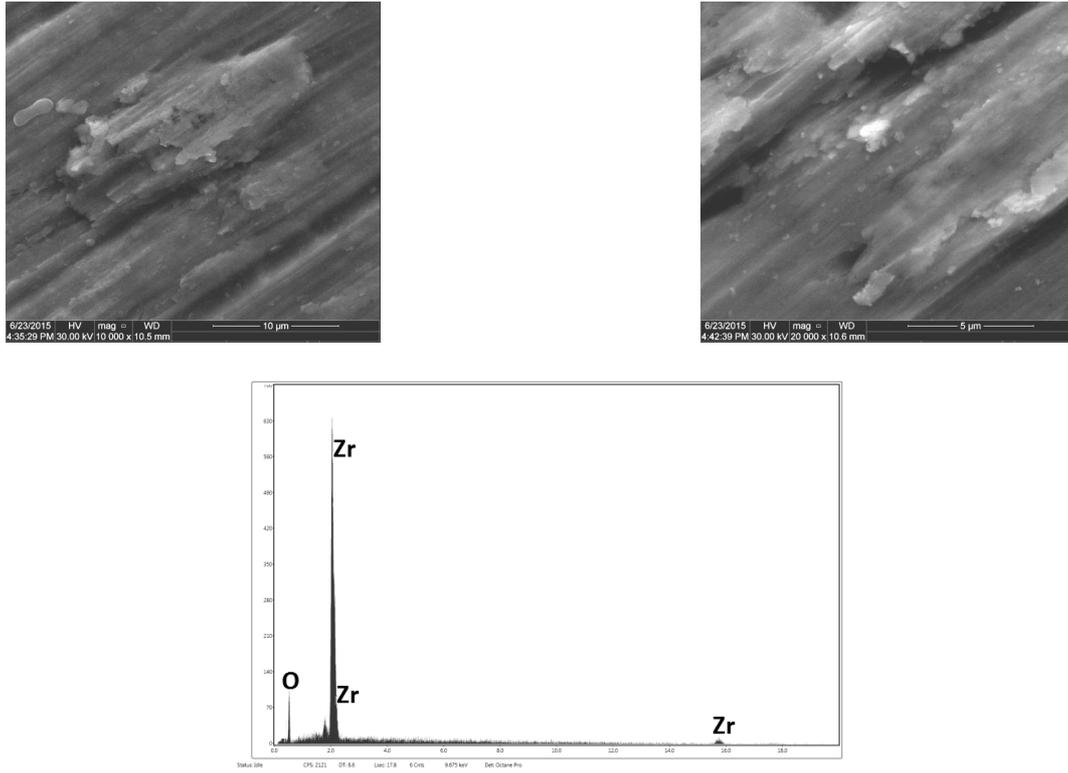
Fig. 4 - SEM micrographs (A) and EDX spectrum (B) of the zirconium alloy anodized at 5 V / *Micrografiile SEM (A) și spectrul EDX (B) ale aliajului de zirconiu oxidat parțial prin anodizare la 5V.*
