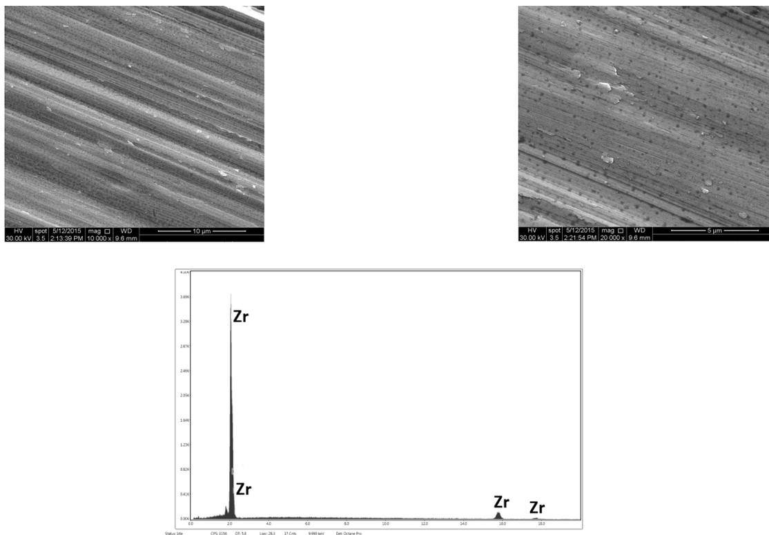
Fig. 2 - SEM micrographs (A) and EDX spectrum (B) of the zirconium alloy / *Micrografii SEM (A) și spectrul EDX (B) ale aliajului de zirconiu.*
