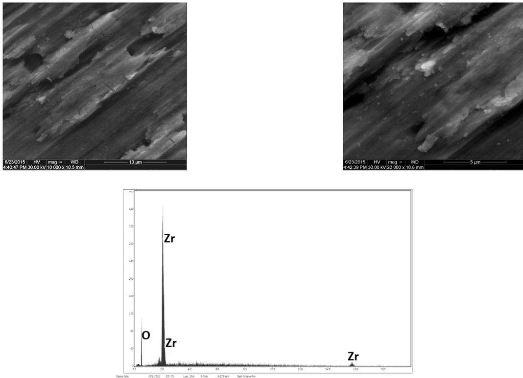
Fig. 5 - SEM micrographs (A) and EDX spectrum (B) of the zirconium alloy anodized at 10 V / *Micrografiile SEM (A) și spectrul EDX (B) ale aliajului de zirconiu oxidat parțial prin anodizare la 10V.*
