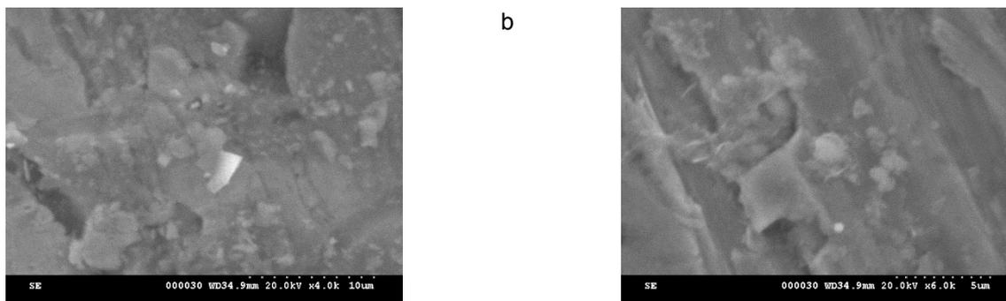
Fig. 9 - SEM imagines of the sample electrochemically treated at 5V (a) and at 10V (b), after 14 days in SBF / Imagini SEM pentru probele obținute prin anodizare la 5V (a) și la 10V (b) după 14 zile menținere in SBF.
