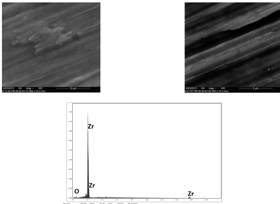
Fig. 3 - SEM micrographs (A) and EDX spectrum (B) of the partially oxidized in air flow at 500°C/2h zirconium alloy / *Micrografii SEM (A) și spectrul EDX (B) ale aliajului de zirconiu oxidat parțial în flux de aer la 500°C/2h.*
