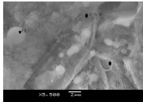
Fig. 16 1-3 Paste SEM morphology(3d,W/B=0.25).
