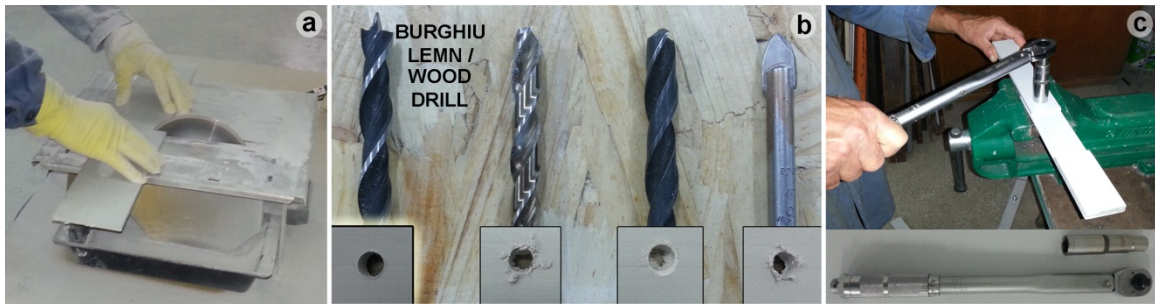
Fig. 2 - Confecționarea epruvetelor / Specimens preparation: a) tăierea probelor / samples cutting; b) selecția burghiului / drill selection; c) aplicarea momentelor de strângere / applying the tightening torque
