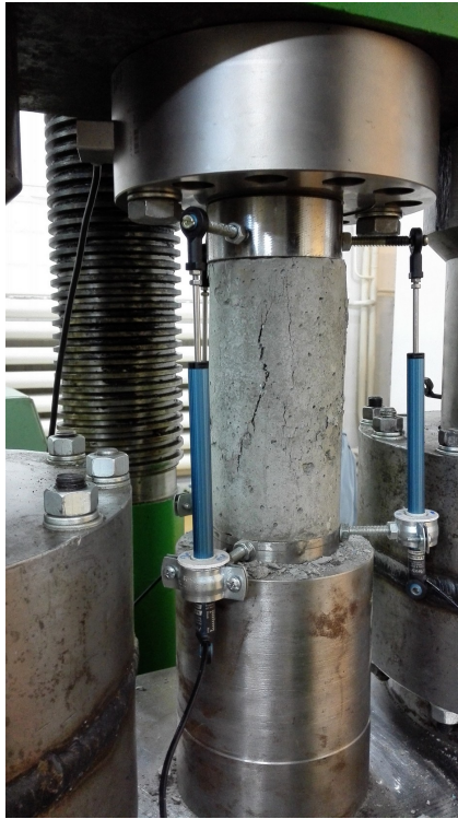
Fig. 9 – Testing of the cylindrical concrete specimens loaded in compression for the complete stress-strain curve: a) MC PET specimen; b) MC PO specimen/ Testarea probelor cilindrice din beton la compresiune pentru obținerea curbelor caracteristice complete tensiune-deformație specifică: a) probă MC PET; b) probă MC PO.
