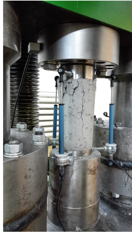
Fig. 9 – Testing of the cylindrical concrete specimens loaded in compression for the complete stress-strain curve: a) MC PET specimen; b) MC PO specimen/ Testarea probelor cilindrice din beton la compresiune pentru obținerea curbelor caracteristice complete tensiune-deformație specifică: a) probă MC PET; b) probă MC PO.
