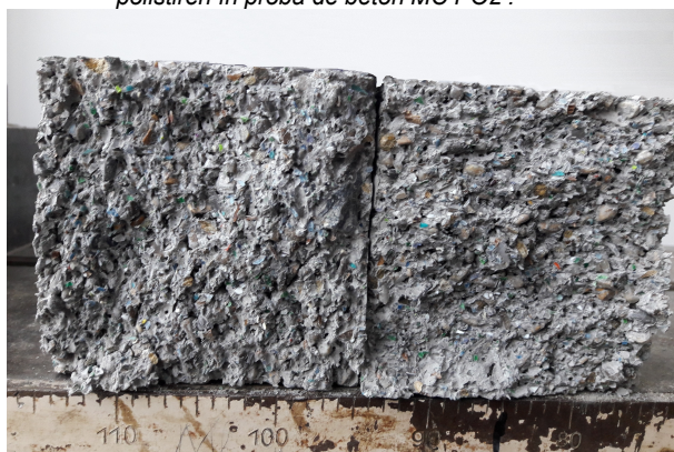
Fig. 3 – MC PET3 quasi-homogeneous distribution of PET particles/ Distribuția cvasiomogenă a particulelor de PET în proba de beton MC PET3 .
