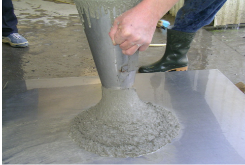
Fig. 2 - Încercarea de tasare / Slump-flow test .
