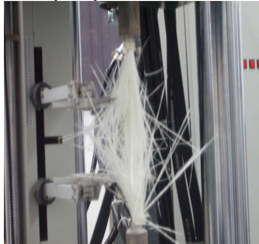
Fig.4 - Ruperea fragilă a barei din CPAFS / Brittle fracture of the GFRP sample.
