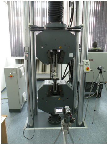
Fig.2 - Pregătirea încercării experimentale/ The experimental setup: (a) - mașina universală de încercat / universal testing machine; (b) - epruveta din CPAFS cu extensometrul montat / GFRP bar specimen with mounted extensometer.
