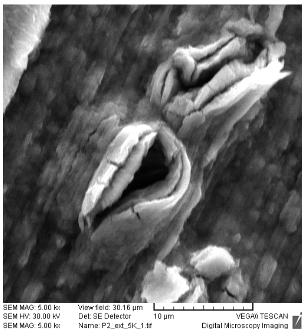
Fig. 11 - Fisuri în stratul de oxid generate de tensiunile termice(P2) / The cracks in the oxide layer due to thermal stresses(P2).
