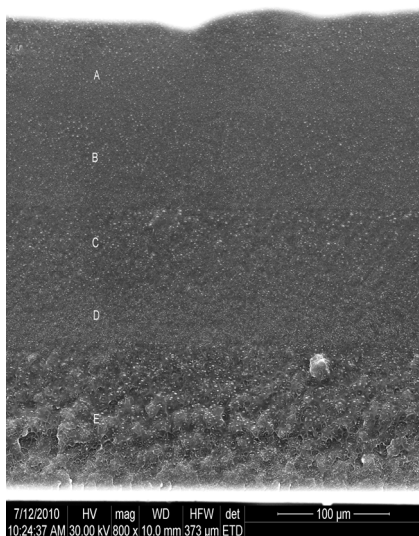
Fig.3 - Imagine SEM (800x) a secțiunii în filmul multistrat, formularea 5 (30% nano silice) utilizând ETD / SEM image (800x) of a section in a multilayer film with formulation 5 (30% nano silica) using EDT.
