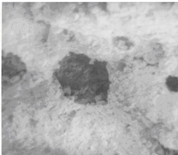
Fig. 1 - Microstructura matricei corespunzatoare unui beton cu 20% ciment, întărită liber timp de 2 zile (x1000)/ The microstructure of the concrete matrix with 20% cement, normal hardened for 2 days (x1000).
